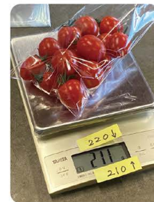
デジタル上皿はかり メモリの上下に計量範囲を貼っている
