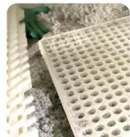
PP (左) でRWをセル底部まで押し込んだ様子
