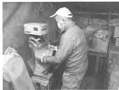
ペレットが湿らないようにするために空気を入れないように袋を閉じます
