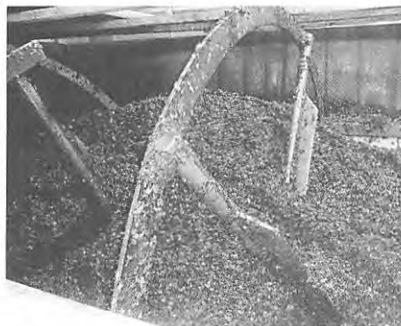
ミキサーに原料をいれます 前日に水分調整しておきます
