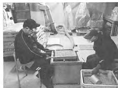
補助具を使って振るいを行いペレットと粉を分別します
